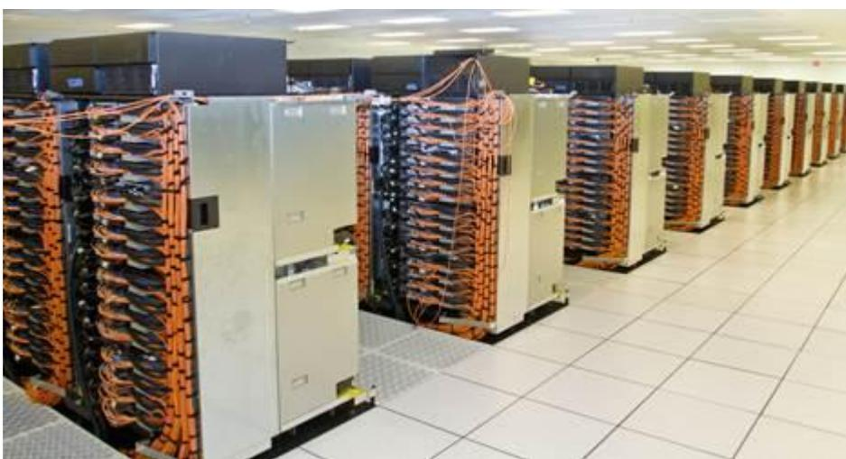
Рис. 2. Часть суперкомпьютера Sequoia, основанного на архитектуре Blue Gene/Q ([Источник](#))
