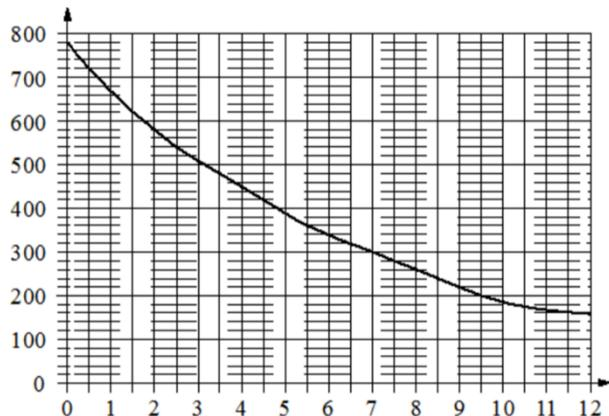
Определите по графику, чему равно атмосферное давление на высоте 6,5 км. Ответ дайте в миллиметрах ртутного столба.
