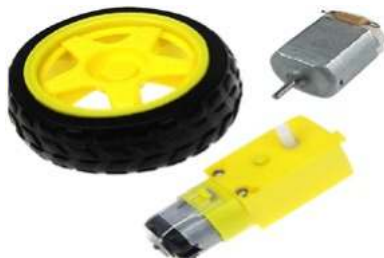
Рис. 18. Двигатели с редуктором
