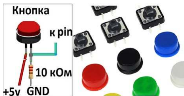
Рис. 1. Схема подключения тактовой кнопки к микроконтроллерной плате
